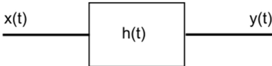
Aquí  $x(t)$  es la entrada del sistema,  $y(t)$  es la salida del sistema y  $h(t)$  es la respuesta al impulso del sistema.
