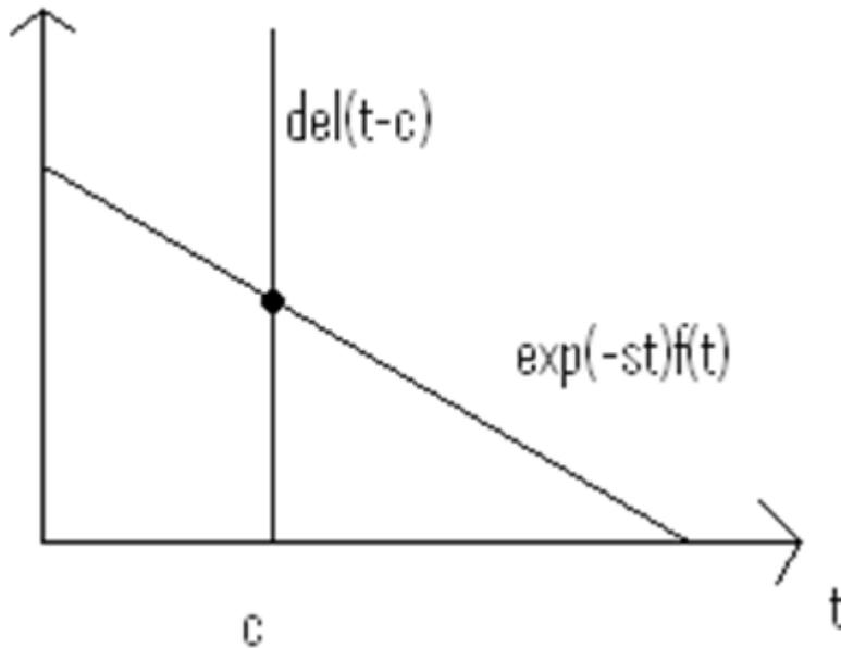
Aquí se dibuja una línea recta donde  $t = c$  ya que el valor de la función delta de Dirac es siempre cero, excepto en  $t = c$ . Por lo tanto, el espacio común de las dos curvas, cuyo valor será determinado por la operación de integración viene a ser un solo punto, el cual es el punto de intersección de las dos curvas, y el valor de la primera función en ese punto será  $e^{-sc} f(c)$ . Este es sólo un punto, el cual tiene un valor constante.
